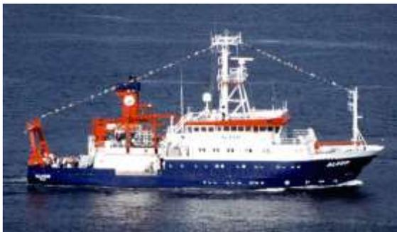
Die ALKOR ist im Einsatz bei dem Institut für Meereskunde / Geomar in Kiel. Sie hat Einrichtungen für 10 Forscher und verfügt über 5 Labors. Vermessen ist die ALKOR mit 1.322 GT bei einer Länge von 55,20 m, einer Breite von 12,50 m und einem Tiefgang von 4,16 m.
