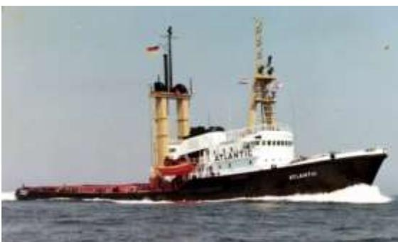
Vermessung: 1.599,76 BRT, 163,36 NRT. Länge: 77,40 m, Breite: 13,20 m, Tiefgang: 5,587 m, achtern maximal 6,671 m. 12.500 PS auf zwei Verstellpropeller brachten sie auf eine Geschwindigkeit von 18,2 Knoten. Der Trossenzug betrug 90 bis 125 tons.
