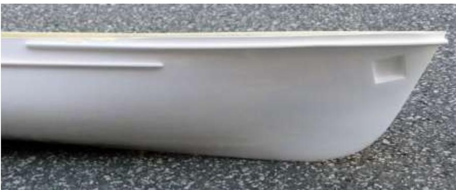
Der GfK-Rumpf ist mit vielen Details ausgestattet, wie Scheuerleisten und Ankertasche. Die Platzverhältnisse im GfK-Rumpf lassen umfangreiche technische Möglichkeiten zu.
