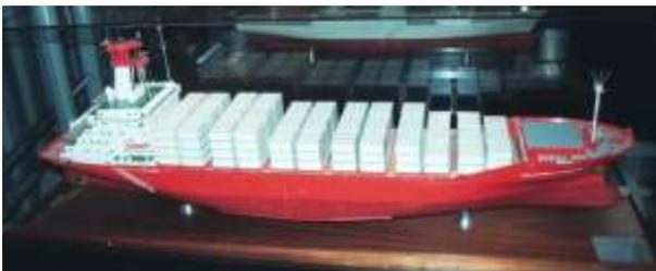
Die COLUMBUS VIRGINIA ist 160,80 m lang, 25,30 m breit, und hat einen Tiefgang von 9,42 m. Vermessen ist sie mit 14.173,15 GT bei 7.847,54 NRT. Sie kann bei einer Tragfähigkeit von 15.790 tdw 1.121 TEU in 7 Luken befördern.
