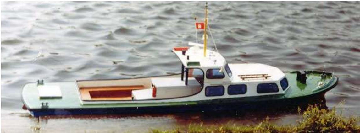
Die OTTER ist ein Modell auch für Anfänger. Das Deck und der vordere Aufbau sind in einem Stück hergestellt. Den oberen Aufbau und den Motorkasten können Sie abnehmen.
