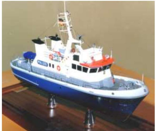
Zwei KHD Dieselmotoren mit je einer Leistung von 1197 kW verhelfen den Schiffen zu einer Höchstgeschwindigkeit von 21 kn. Zum besseren Manövrieren haben diese Schiffe ein Bugstrahlruder.
