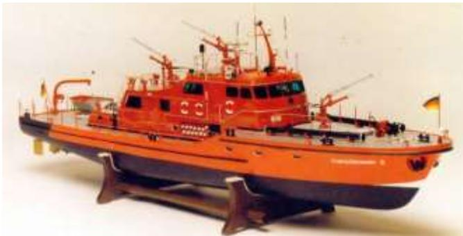
Die KÖLN, die DÜSSELDORF und die DUISBURG wurden allesamt verlängert durch Einsetzen eines 5,26 m langen Mittelteiles, wodurch das Modell im Maßstab 1:25 immerhin um 21 cm länger wurde. Diese Verlängerung begünstigt die Platzverhältnisse und ermöglicht die Platzierung eines großen Kranes und eines Beibootes.
