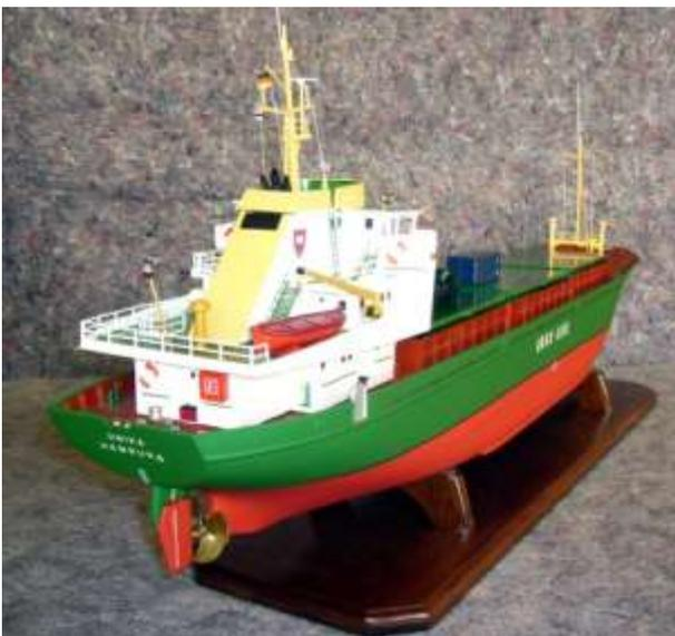
Die Johanna gehört zu einem Serienbau der Hugo Peters Werft. Bei einer Länge von 76,54 m und einer Breite von 12,83 m haben die Schiffe einen Laderaum mit 3670 Kubikmetern Rauminhalt und 3 Luken. Sie erreichen eine Geschwindigkeit von über 12 kn.
