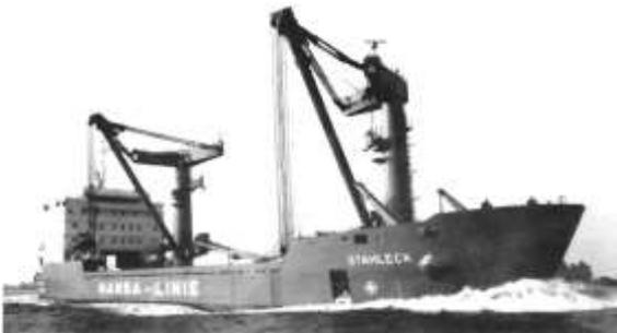
Die STAHLLECK, lässt sofort erkennen, was sie bewegen konnte. Ausgerüstet war sie mit zwei 216 t. Bäumen, in Kombination 416 tons, sowie schwergutbelastbarer Bug- und Heck-Rampe. Der minimale Tiefgang von nur 5,15 m erlaubte dem Schiff, selbst auf Flüssen zu operieren. Bei einer Länge von 91,38 m, einer Breite von 16,82 m war sie sehr handlich.
