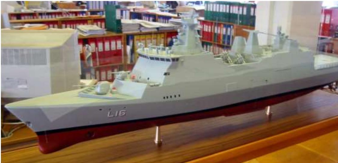
Die etwas ungewöhnlich klassifizierten Schiffe der Absalon-Klasse werden auch als „Flexible Unterstützungsschiffe“ oder „Kampfunterstützungsschiffe“ bezeichnet. Sie basieren auf einem Fregatten-Design mit einem Mehrzweckdeck, das über eine Verloaderampe verfügt.
