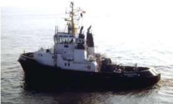
Die BREMERHAVEN ist vermessen mit 368 GRT, ist 29,23 m lang, 10,00 m breit und hat einen Tiefgang von 3,50 m.
