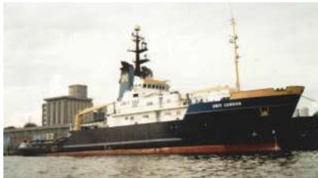
Bei einer Länge von 74,75 m und einer Breite von 15,68 m ergibt sich im Maßstab 1:50 ein Modell mit ca. 35 kg Verdrängung!
