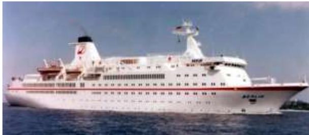
1986 wurde die BERLIN um ca. 17 m bei der Nobiskrug Werft in Rendsburg verlängert. Damit wuchs die Länge von 122,5 m auf 139,3 m. Durch die Verlängerung wurde die optische Harmonie der ursprünglichen Konstruktion erheblich gestört, da bei der eingesetzten Sektion ein weiteres Rettungsboot „oben drauf“ gesetzt“ wurde. Außerdem ist das Schiff „viel zu lang“ geworden, bzw. hat ein ungünstiges Längen-Breiten-Verhältnis bekommen.
