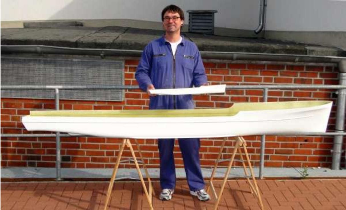
Hier zum Größenvergleich ein Rumpf M 35 im Maßstab 1:100 (in der Hand, 68 cm lang) und der viermal größere Rumpf im Maßstab 1:25 mit 2,72 m Länge.
