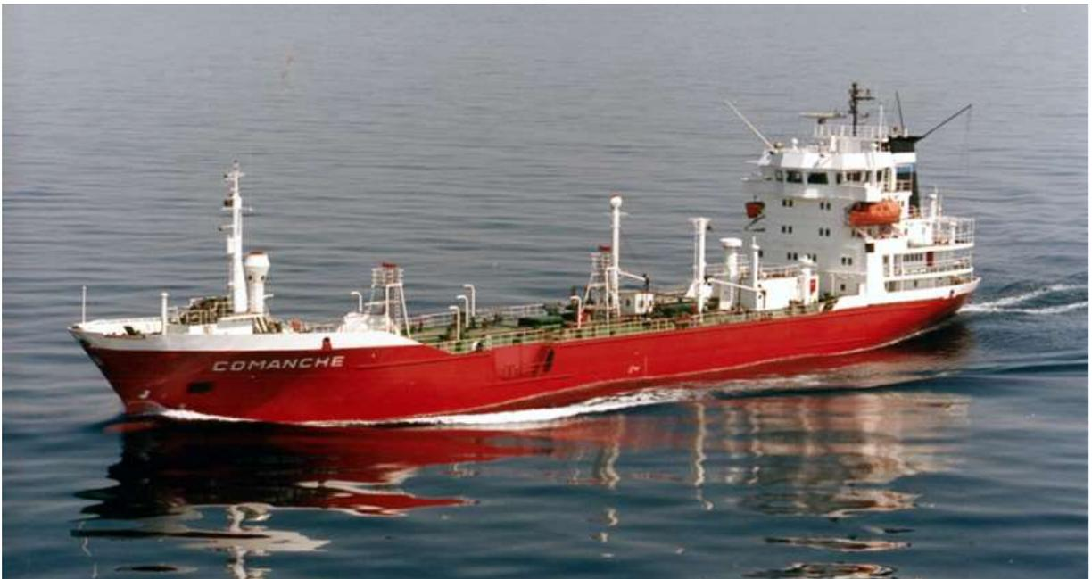
Die Aztek sowie deren Schwesterschiffe Apache und Comanche wurden auf der Lindau-Werft in Kiel gebaut und verfügen über 13 Edelstahl-Tanks. Der Antrieb ist ein MaK Dieselmotor von 1655 kW. Durch diesen erreicht das Schiff eine Geschwindigkeit von 13 kn.
