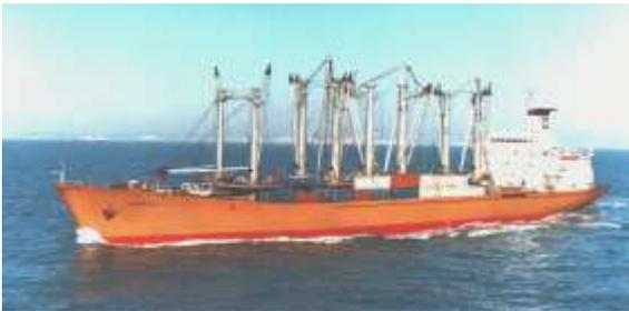
Ein sehr schöner, konventioneller Frachter aus den 60er Jahren mit 5 Luken und einem Ladevolumen von 15.521 Tons. Vermessen ist die MANGAN mit 11.382,90 BRT, 6.931,22 NRT. Die MANGAN ist 168,51 m lang, 22,86 m breit und hat einen Tiefgang von 9,03 m. 21 Ladebäume von 3 bis 50 Tons fordern Sie als Modellbauer.
