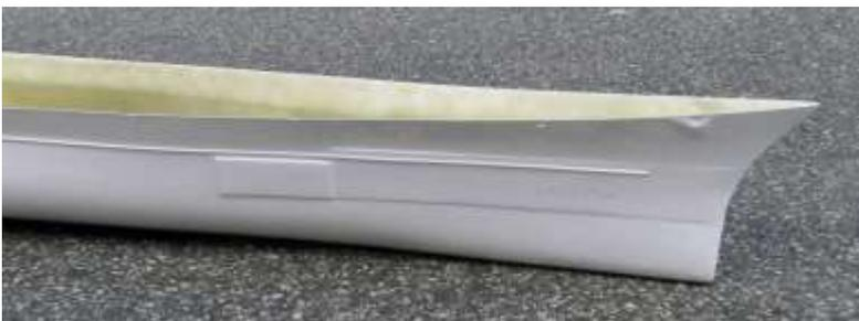
Am Rumpf sind Bullaugen, Gürtelpanzer, MES-Kabel, Ankerwulst und Ankertasche sowie Schlingerkiel angeformt.
