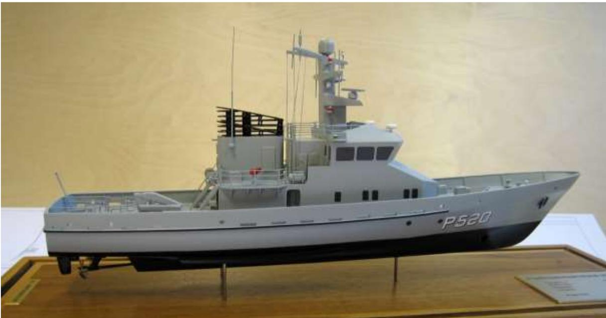
Rumpf und Aufbauten sind auch beim Original aus glasfaserverstärktem Kunststoff.
