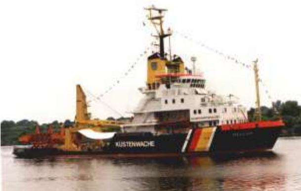
Die MELLUM wurde auf der Elsflether Werft gebaut und ist fortan beim Wasser- und Schifffahrtsamt Wilhelmshaven beheimatet. Vier MAK - Dieselmotoren mit einer Gesamtleistung von 9 000 PS verhelfen dem Schiff zu einer Geschwindigkeit von ca. 16 kn. Zur Steuerung gehören Beckerruder, Verstellpropeller und Bugstrahlruder.
