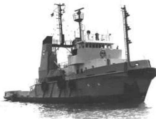
Die OTTERTURM hat eine Länge von 44,40 m, ist 11,02 m breit, und hat einen Tiefgang von 4,85 m. Vermessen ist sie mit 495 BRT, gebaut 1976 als Baunummer 733 bei den Scheepswerven H. H. Bodewes in Millingen, Holland für die DDG „Hansa“ in Bremen. Ausgerüstet mit 2 MWM-Dieseln von je 2.800 PS wird ein Zug am Pfahl von 80 t erreicht. Ebenfalls gehört eine 150 t Ankerzieh- und Schleppwinde zur Ausrüstung.
